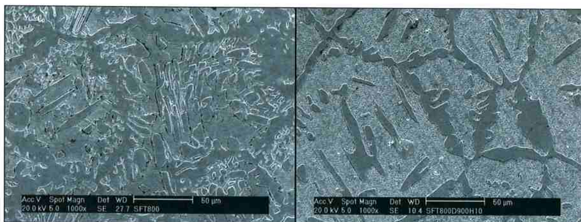
Figura 16 – Comparação entre pré e pós tratamento de dissolução.
