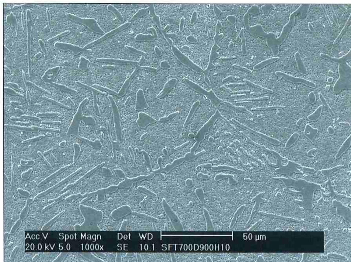
Figura 12 – Região da amostra B, após tratamento de dissolução.
