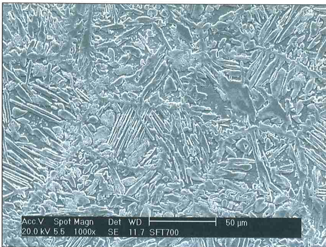
Figura 11 – Região da amostra B, com fase sigma copiosamente precipitada.
